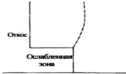
Рис. 23. Схема разрушения ослабленного вертикального склона
