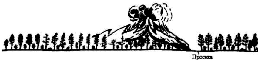
Рис. 45. Пуск встречного огня при тушении лесного пожара отжигом
